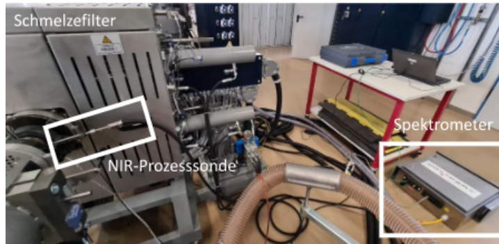
Abbildung 12 Einbau der NIR-Prozesssonde nach Schmelzefilter der Intarema 906 TE (eigene Abbildung SKZ).
