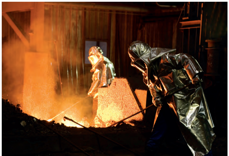
Abstich am Hochofen in der Eisenproduktion
