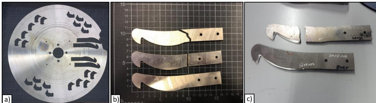
Abbildung 1-28: Abbildung der durch das Wasserstrahlschneiden gebrochenen Kreismesser und Rohlingen. a) gerissenes und gebrochenes Kreismesser, b) gebrochene Rohlinge des Pappreißmessers mit Hakenklinge und c) korrodierte und während des Schleifprozesses gebrochenen Pappreißmesser mit Hakenklinge.
