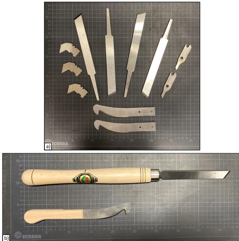
Abbildung 1-30: Abbildung von ausgeschnitten Demonstrator-Werkzeugen durch den Repurpose-Prozess. a) unterschiedlichste gefertigte und geschliffene Demonstratoren der Firmen Kirschen und Freund, b) fertig montierter Repurpose-Drehselbeitel (oben) und Pappreißmesser mit Hakenklinge (unten).
